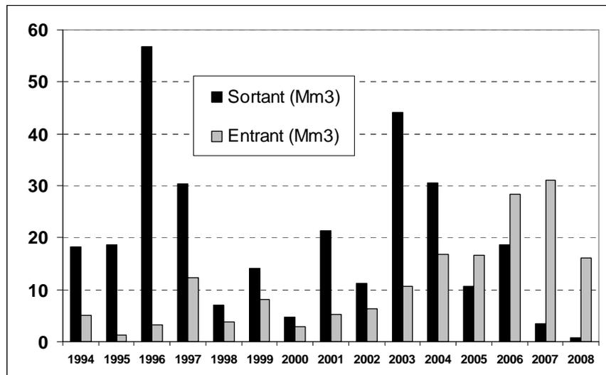
Figure 3 : Bilan des échanges d'eau par les vannes du pertuis de la Fourcade (en millions de m<sup>3</sup>) de 1994 à 2008.
