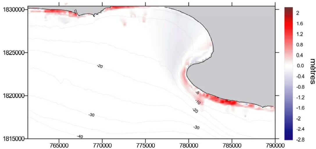
*Figure 6. Evolution de la hauteur de houle entre 1974 et 2005. Cet exemple représente l'évolution d'une houle significative de 4m et de période 8 secondes (valeur en entrée du modèle) propagée à partir du modèle spectral STWAVE.*
