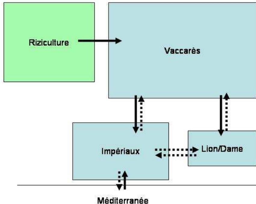
**Figure 2 :** Représentation schématique de l'hydrosystème simplifié de l'Île de Camargue, avec les flux d'eau principaux pendant la saison de culture (flèches noires) et les flux d'eau possibles pendant les autres saisons (flèches pointillés).
