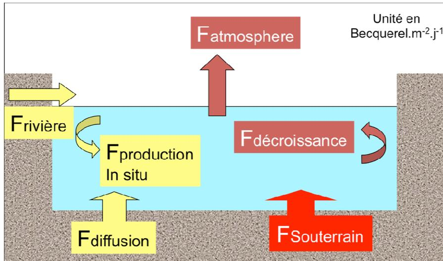
Figure 1 : Flux de radon-222 entrant et sortant dans l'étang du Vaccarès. Si le système est en équilibre, la somme des flux entrants (en jaune et rouge) doit être équivalente à celles des flux sortants (en bleu). Le flux apporté par les eaux souterraines doit donc être égal à : Rivières + production + diffusion – Décroissance – atmosphère.
