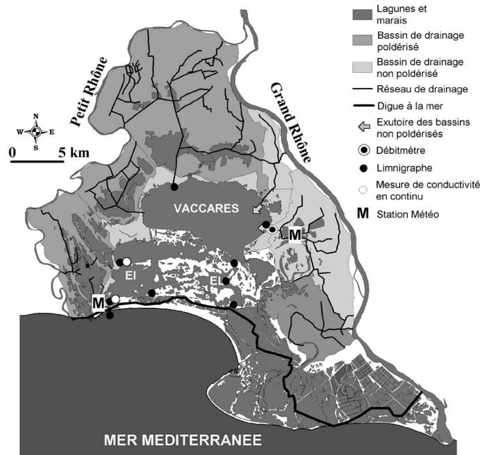
Figure 1 : Réseau de mesures en continu (débitmétrie, limnimétrie, conductivité) et postes météorologiques principaux dans l'Ile de Camargue.
