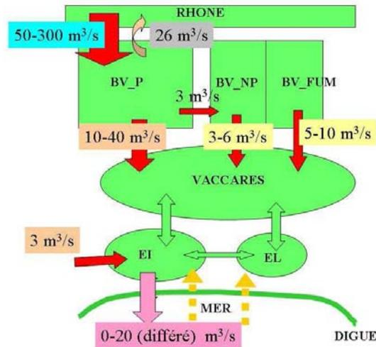
Figure 2 : Représentation schématique de l'hydrosystème en fonctionnement "de crise": brèche sur les digues du Petit Rhône avec pluvial intense. (P, NP : (non) poldérisé ; EI « Etang de l'Impérial » ; EL « Etang du Lion »)
