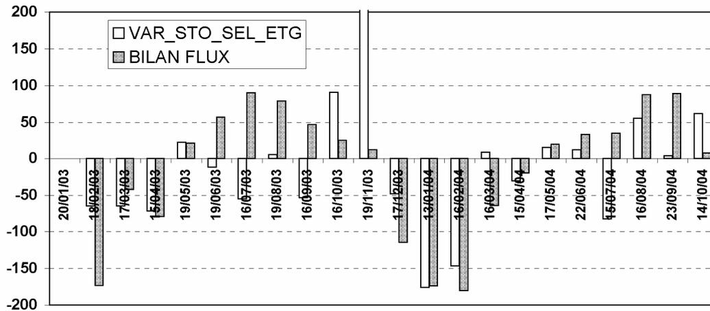
Figure 5 : Comparaison des bilans de masse mensuels de sels (en milliers de tonnes de sel) estimés par variation du stock (VAR\_STO\_SEL\_ETG) dans l'eau des étangs entre 2 dates et par bilan des entrée –sorties (BILAN FLUX) (depuis / vers la mer ; depuis le bassin versant).
