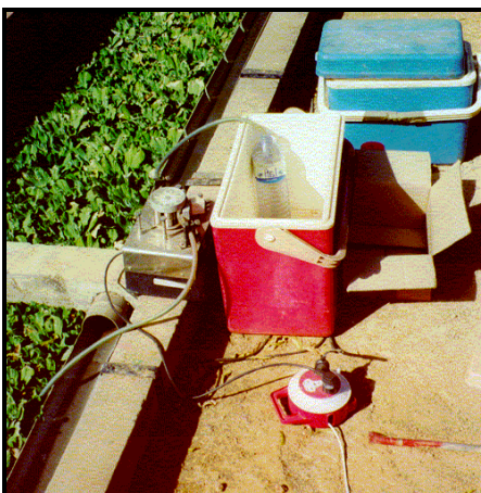
Figure 4.4 : Appareillage de prélèvement pour le traçage au lithium
