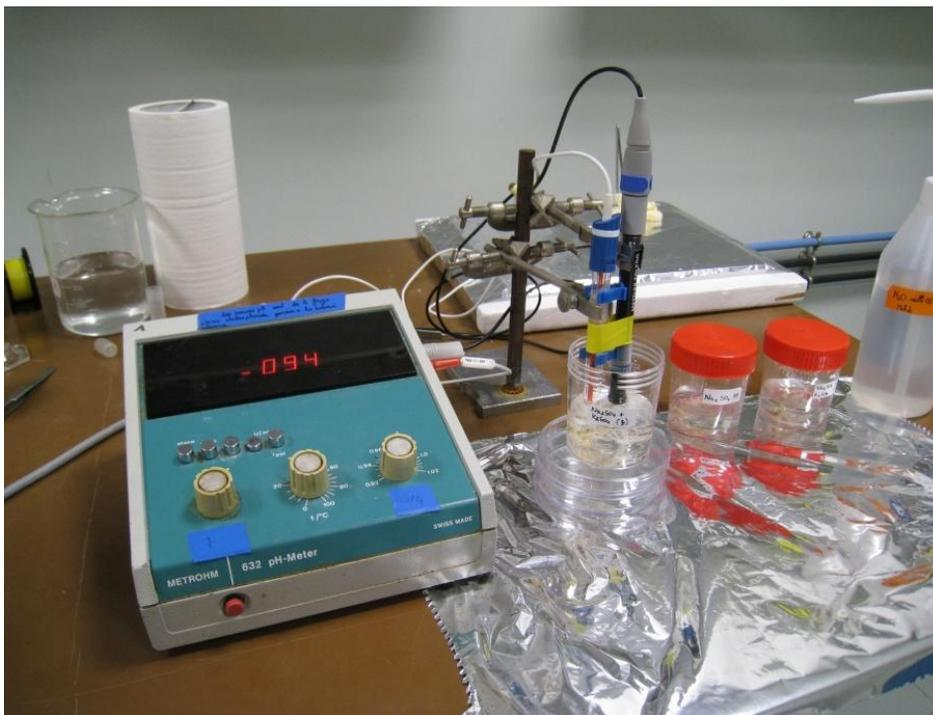
**Figure II.8. Dispositif expérimental de mesure de flux nets racinaires de potassium à l'aide d'une électrode ion-sélective.**
