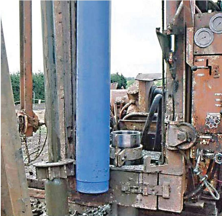
Le coût unitaire d'un tubage en PVC tel que celui-ci peut être inférieur de 50 % à celui d'un tubage en acier.
