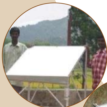
Condenseur standard de 1 m 2 incliné de 30° par rapport à l'horizontale
