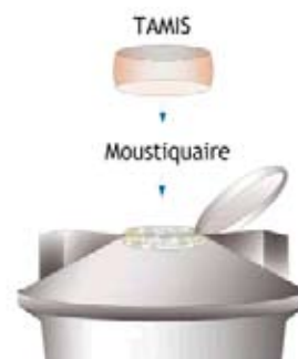
Figure 11: Système de filtration amélioré proposé et testé par la DSDS
