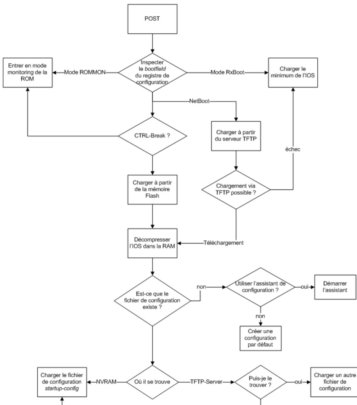
FIGURE 5 – Processus de démarrage d'un routeur CISCO
