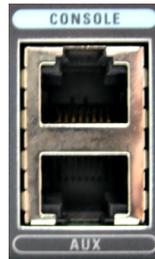
FIGURE 2 – Ports console et AUX d'un 1721. Nous n'utiliserons que le port console (en haut), signalé par le texte CONSOLE, sur fond bleu ciel.
