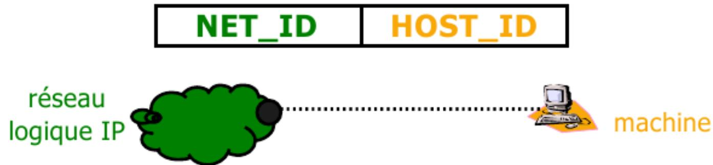
Pour décomposer une adresse IP (c'est-à-dire séparer le *netid* du *hostid*), il faut utiliser un **masque (*netmask*)**. Chaque équipement effectuera une opération **ET (bit à bit)** entre l'adresse IP complète et le masque.
