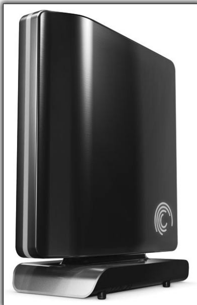
Figure 1.3 : Un disque dur externe est dans un boîtier individuel qui se connecte à l'ordinateur
