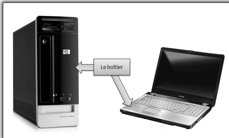
Figure 1.1 : Le boîtier d'un ordinateur de bureau et l'équivalent sur un ordinateur portable
