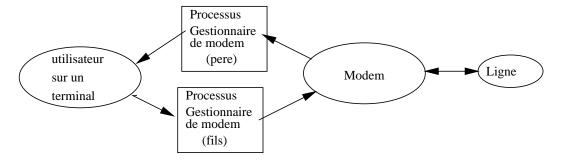
Fig. 17.2 - Un gestionaire de modem avec deux processus
