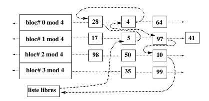
Fig. 3.5 – Scénario 2- Demande d'un tampon pour le bloc-disque 41.
