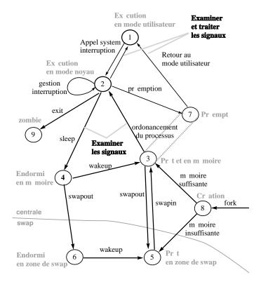
Fig. 6.8 - Diagramme d'état des processus
