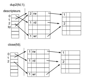
Fig. 5.3 - Redirection de la sortie standard sur "toto".
