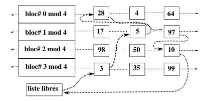
Fig. 3.4 - Scénario 1- Demande d'un tampon pour le bloc-disque 4.
