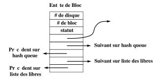
Fig. 3.1 - Structure des entêtes de Bloc du Buffer Cache
