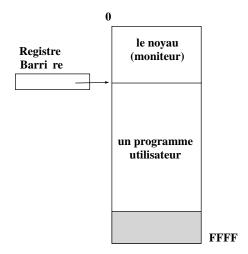
Fig. 8.4 - Protection du moniteur par un registre barrière.
