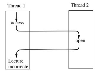
Fig. 18.3 - Changement de la valeur errno par une autre thread
