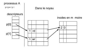
Fig. 10.1 - Ouverture d'un tube
