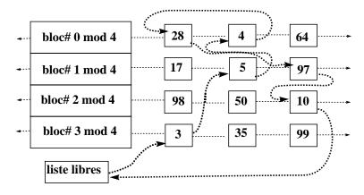
Fig. 3.3 – Etat du buffer cache avant les scénarios 1, 2 et 3.
