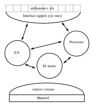
Fig. 18.1 - Plusieurs modules système qui utilisent un noyau réduit
