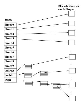
Fig. 2.3 - Adressage direct et indirect des inode UNIX
