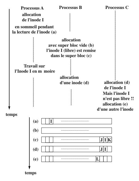
Fig. 2.10 - Faille de l'algorithme d'allocation.
