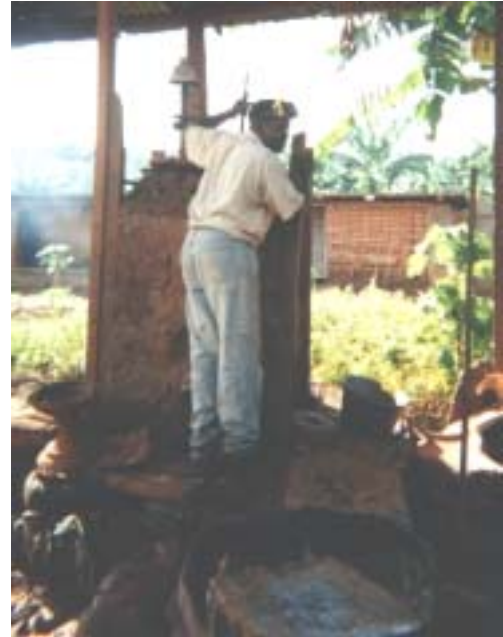
Figure 6 : artisan récupérateur chargeant son four de déchets de PE
