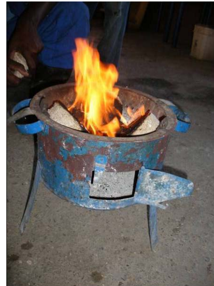
Combustion de 3 bûchettes sur un foyer de cuisine
