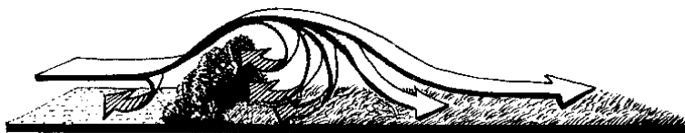
Figure 13 : Lorsque le rideau-abri bloque complètement le vent, de la turbulence se produira derrière les arbres et endommagera les cultures.
