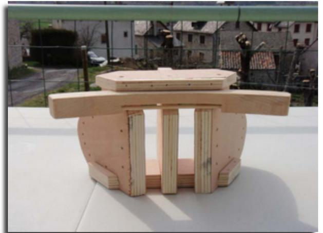
Puis on monte le gabarit en vissant les différents éléments, on met en place l'arceau principal et on l'attache solidement. Poser les 5 curseurs principaux de la face avant et les 5 curseurs arrière en les attachants avec du fil de fer fin sur le gabarit, pour la mise en forme des curseurs s'aider de clous.
