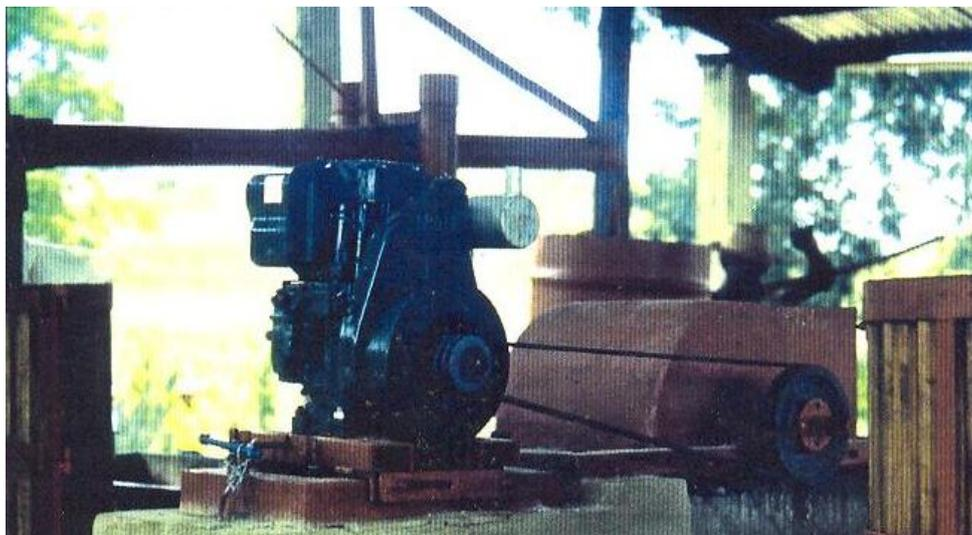
Ici la râpe est mue par un petit moteur Diesel monocylindre refroidi par air.
