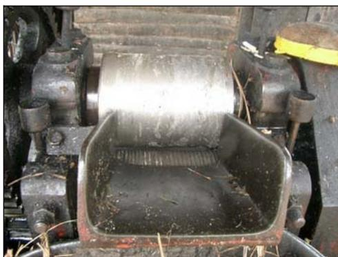
**Fig. 31 : trémie d'alimentation des moulins écartant les mains de l'utilisateur de la zone de danger, les roles sont à une distance de l'auge supérieure à la longueur d'un bras.**
