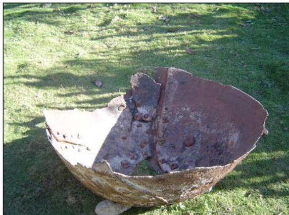
**Fig. 38 : ancienne cuve en fonte réparée à de multiples reprises**
