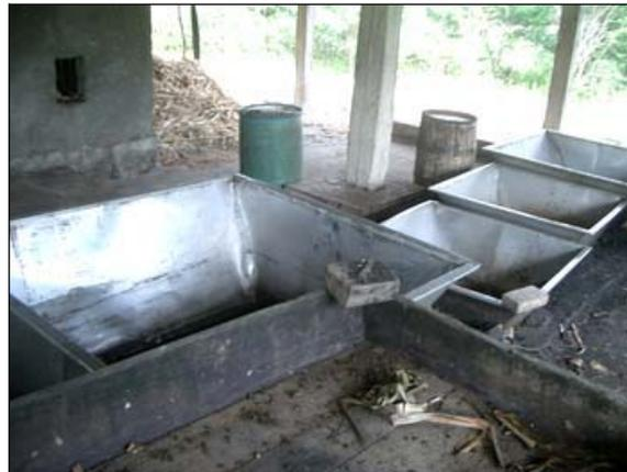
**Fig. 35 : cuves en inox du SOE**
