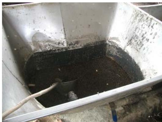
**Fig. 37 : cuve en acier - inox SOE faute d'une réflexion ces cuves ont été installées sans s'inscrire dans le foyer lui-même ce qui provoque un gaspillage d'énergie**
