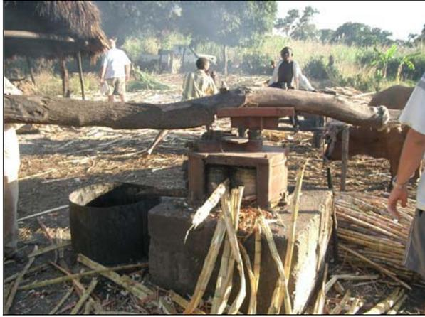
**Fig. 19 : socle en maçonnerie du moulin Paleta**
