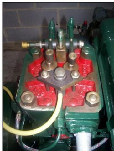
Retirer le tuyau reliant le réservoir au filtre à mazout et le tuyau du retour des injecteurs. (Clé ½ BS + 5/16 BS).
