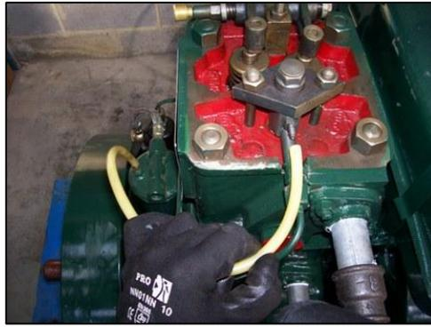
Démonter le réservoir en desserrant les 4 vis se trouvant sur les flancs du cylindre.
