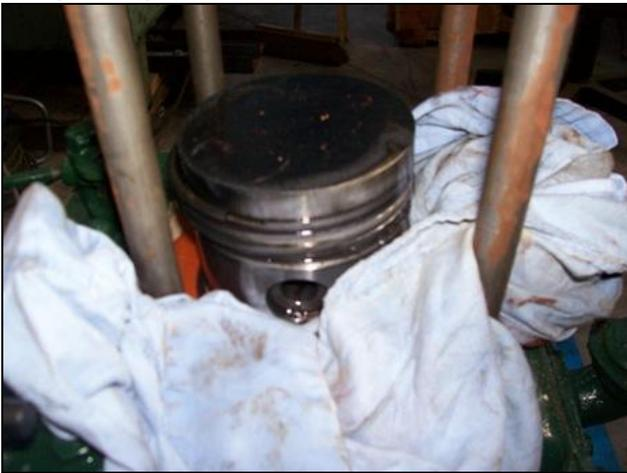
Retirer les 2 circlips maintenant l'axe piston-bielle. (Pince circlips)
