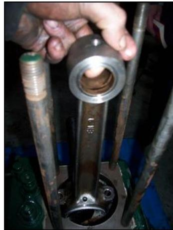
Démonter les 4 écrous des 2 paliers du vilebrequin et sortir les paliers.(Clé ½ Bs) et démonter le tuyau d'alimentation de la pompe à huile afin de pouvoir démonter le palier.
