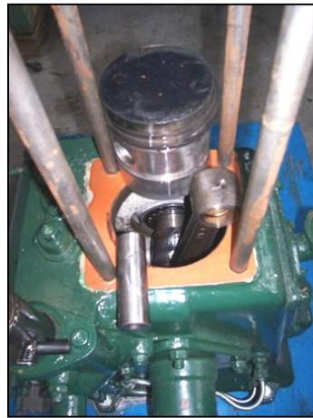
Retirer le piston et son roulement (il s'agit d'une buselure de bronze)
