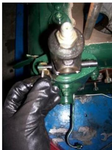
Démonter les 2 vis fixant la pompe à injection sur son socle. (Clé 3/8 BS)
