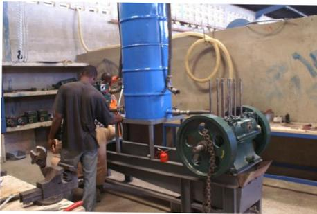
Le refroidissement fonctionne par un système de thermo siphon.
