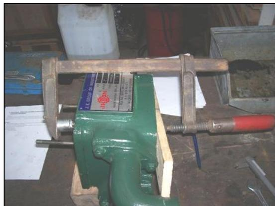
Démonter les guides de soupapes à la presse, contrôler la force nécessaire pour leur démontage (monté légèrement serrant). (facultatif)
