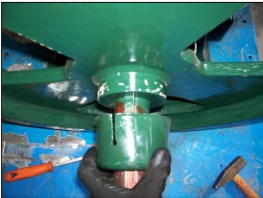
Retirer les 2 clavettes biaisées fixant les 2 volants d'inertie sur le vilebrequin
