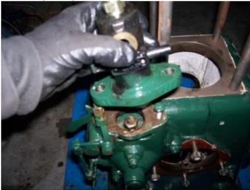
Démonter le circuit interne de lubrification du moteur. (Clé 1/2 et 3/8 BS)
