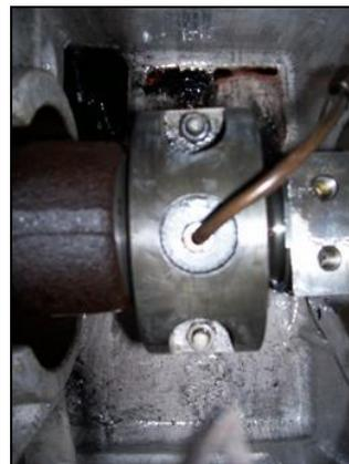
Il faut démonter également l'engrenage servant à la transmission entre le vilebrequin et l'arbre à cames en frappant sur la vis supérieure du palier avec 4 vis, il se dégage facilement.(si possible marquer cet engrenage, celui du vilebrequin et de l'arbre à cames pour le remontage comme à l'origine)
