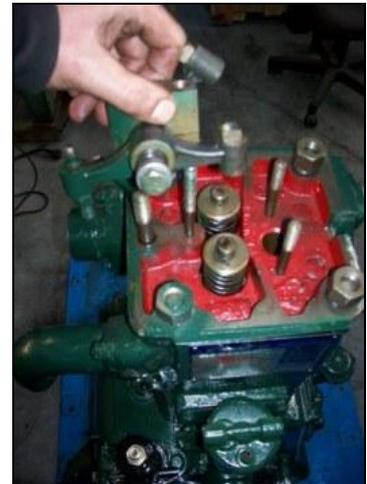
Retirer les 2 écrous des goujons fixant l'injecteur. (clé 7/16 BS)
