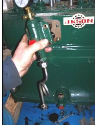
Démonter une partie de la tuyauterie également entre le moyeu central et un petit distributeur se trouvant à l'intérieur, au-dessus dans le carter du moteur (pour le distributeur, facultatif)
