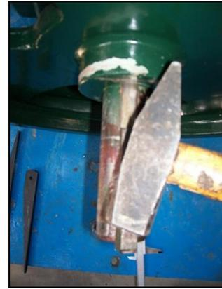
Retirer l'enduit de protection au thiner se trouvant sur les 2 bouts d'axe du Vilebrequin.
