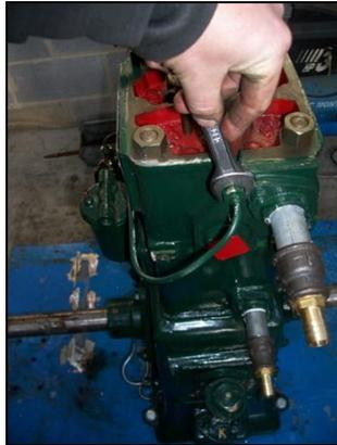
Retirer les 2 écrous des goujons fixant l'ensemble culbuteur et tige de culbuteur ;
