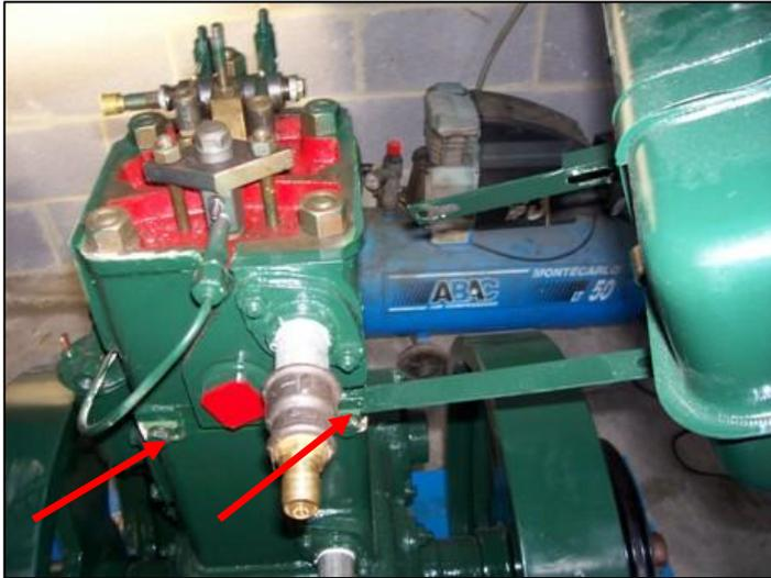
Retirer la poulie (1/2) et les 2 cloches de protection sur le vilebrequin (tournevis et marteau)
