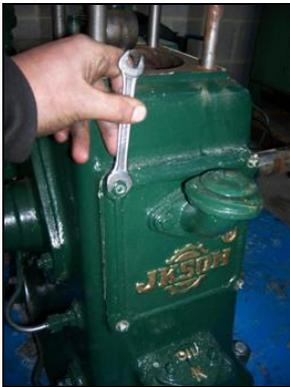
Retirer les 2 goupilles de sécurité des écrous et démonter les 2 boulons fixant la bielle au vilebrequin.
