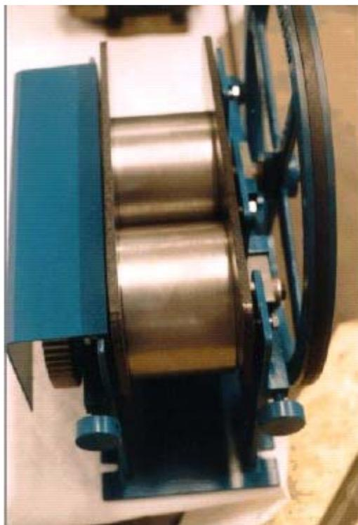
Nous avons passé la pâte sortant du moulin à meules métalliques dans un laminoir à cylindre (ouverture 0mm, diam. cylindrique 180mm).
