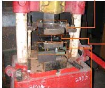
presse montée avec l'outillage
