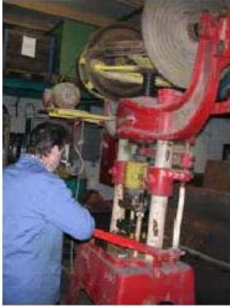
La presse utilisée est une presse mécanique à friction de + - 20 t.
