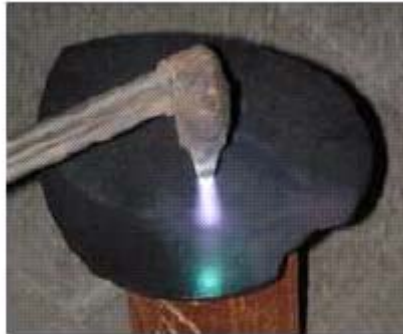
chauffage du flanc au chalumeau
