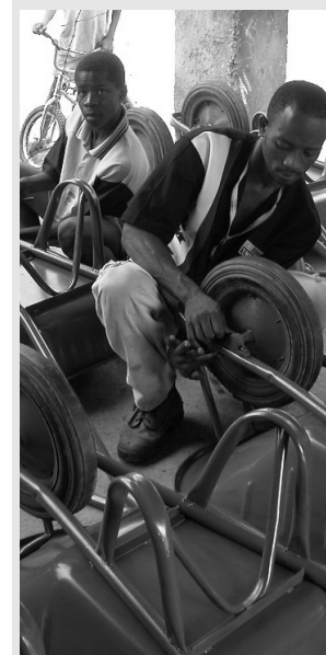
Figure 2: Fixation des paliers de la roue
