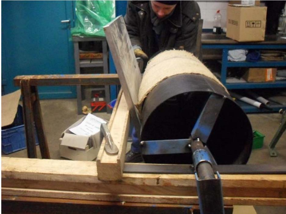
Figure 26 Prototype d'un séparateur à rouleau
