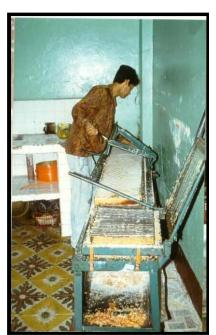
Des artisans de la région offrent des petites machines pour la coupe de la pâte. Ces machines manuelles sont faites sur mesure suivant les dimensions souhaitées par le producteur de pâte. On peut aussi trouver des machines qui coupent dans les deux sens, on obtient donc directement le morceau de pâte aux dimensions souhaitées en évitant une manipulation.
