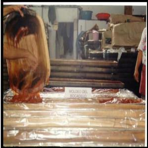
L'opérateur retire la pâte de la cuve au moyen d'un racloir en bois.
