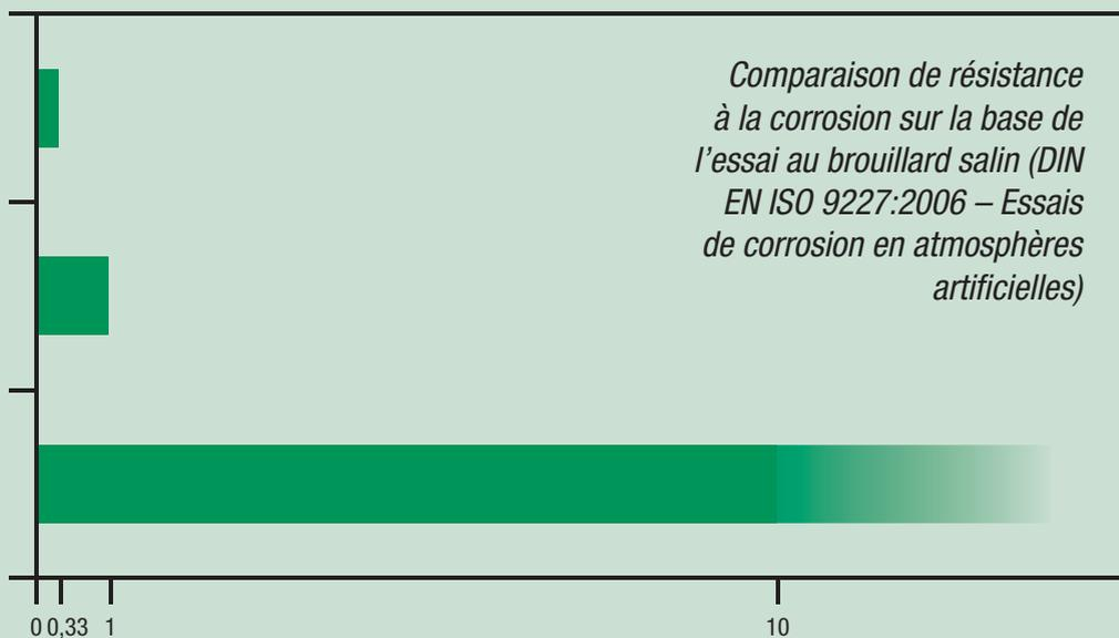
Tenue à la corrosion relative au zingage-bichromatage jaune (4 – 6 µm)
