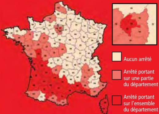
Une protection contre les termites doit être mise en place entre le sol et le bâtiment. Toutes les constructions neuves dans les départements dans lesquels a été publié un arrêté préfectoral mentionnant la présence de termites souterrains, doivent être protégées préventivement vis-à-vis de cet insecte.
