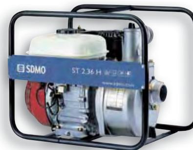
► **Motopompe ST2.36H. Moteur Honda GX120. Diamètre d'aspiration 50 mm. Débit maximum 600 l/mn. 36 m³/h. Hauteur d'élevation 29 m SDMO**
