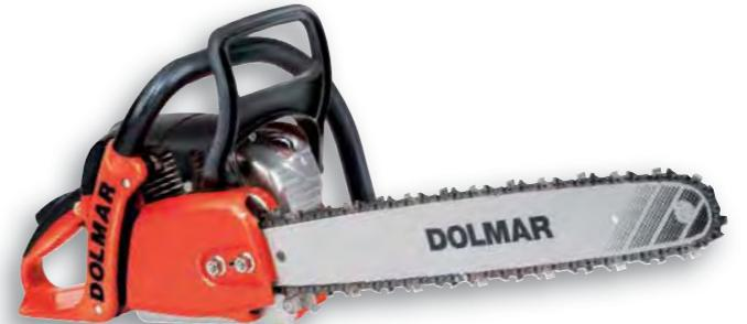
► Tronçonneuse thermique PS420CS40. 42,4 cm<sup>3</sup>. 2,7 ch. Longueur de coupe 40 cm. Réservoir 0,48 l. 4,8 kg **DOLMAR**
