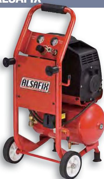
► **Compresseur électrique monophasé ALAIR 10/200 OILESS.** 2 cv. Cuve de 10 litres. Alimentation 230V - 50Hz. Débit 198 l/min. Pression max 8 bars. Sans huile. 23 kg **ALSAFIX**
