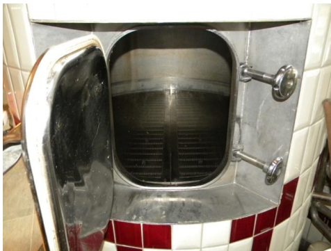
Figure N°3 Cuve de filtration de la Gérômoise ; (Photographie Thomas AHOANGNIMON)
