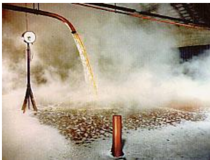
Figure N°6 : Arrivé du mout dans la cuve de refroidissement ; ( http://home.scarlet.be/pajottenland/fr/payot/biere/lambic.htm )
