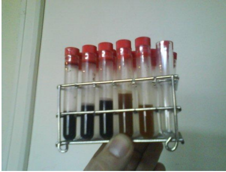
Figure N°2 Test de l'avancement des paliers de saccharification lors d'un essai de brassage de lambic: à gauche, l'iode se colore en bleu palier incomplet à droite aucune coloration: saccharification terminée ; (Photographie Thomas AHOANGNIMON)
