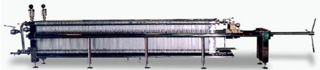
*Fonctionnement de la filtration , à l'aide de kieselgur ou de feuilles en carton (Sheet). Le centre de la machine peut être compressé pour diminuer l'espace entre les feuilles ou entre les kieselgurs pour une filtration plus efficace*
