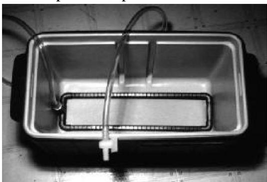
Figura 12: - El manifold de lautering está ahora instalado en el fondo de la heladera. Su diseño depende de con qué se trabaja.
