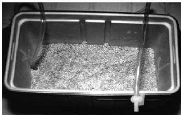
Figuras 13 & 14: - Estos dos tipos de recipientes de enfriado del mash/lauter son parte de un sistema de tres niveles de gravedad. Un dispositivo de tres niveles no es necesario cuando se usa una heladera, esta es simplemente la manera en que yo lo hago. Más frecuentemente los fabricantes usan la heladera en la cocina, y hierven en otros recipientes. Yo me acostumbré a hacerlo de esta manera desde que mi esposa decidió que ella quería mi hobby fuera de su cocina.
