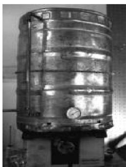
Figura 15: - Este es el tanque que uso para el agua caliente extra. Es un barril de cerveza de acero inoxidable convertido, con la parte de arriba cortada y accesorios instalados.
