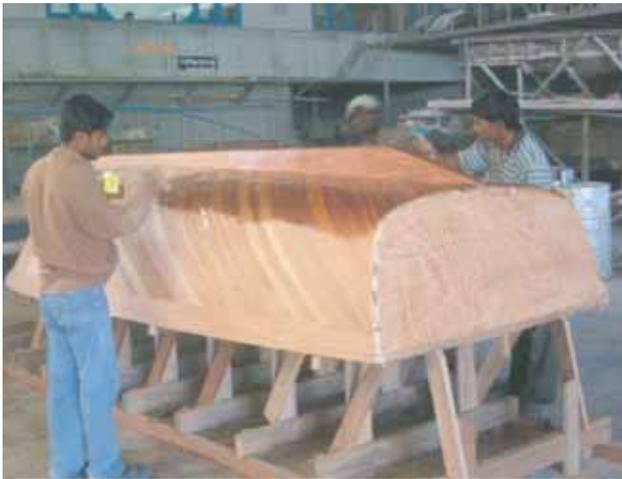
Une fois le ponçage achevé, la surface de bois est rendue étanche/recouverte d'un enduit et préparée pour la couche de stratifié.
