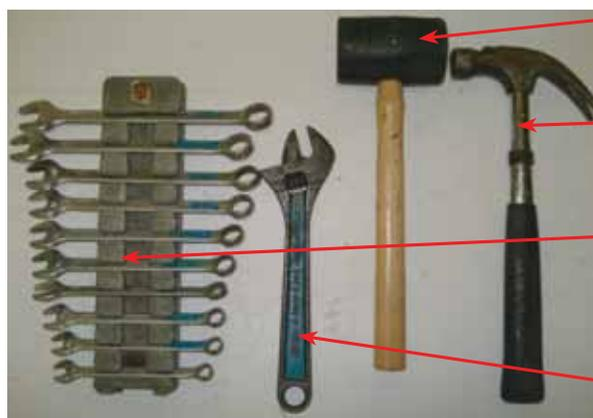
Les maillets en caoutchouc sont utiles pour taper doucement sur les moules et faciliter le démoulage.
