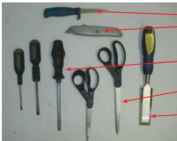
Un couteau classique ou un cutter avec des lames de rechange peut être employé pour couper les tissus secs ou le stratifié «en gel» à partir des bords.
