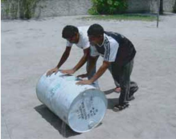
Si l'on ne dispose pas d'une perceuse avec un embout mélangeur approprié, le mieux est de faire rouler le fût.
