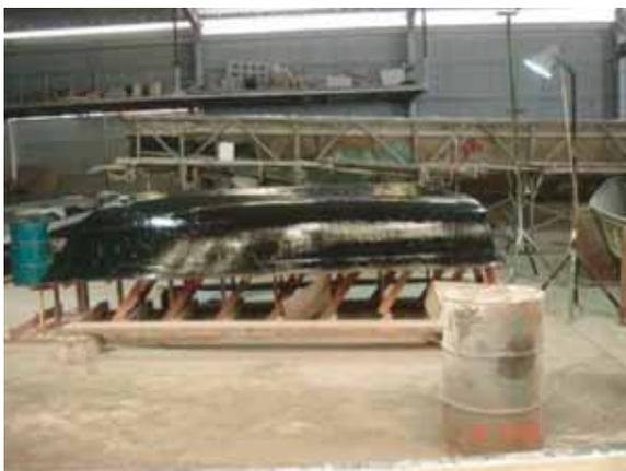
Il faut utiliser du véritable «Gelcoat de moule» sur la pièce mère, et non pas simplement du gelcoat ordinaire de couleur noire. Le gelcoat de moule est généralement plus dur que le gelcoat ordinaire, il a une excellente capacité de brillance et il se rétrécit moins.
