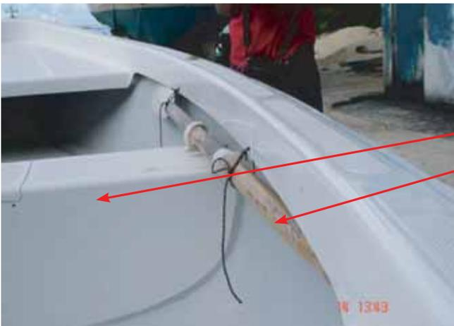
Banc de nage fixé et mis en place avec les avirons rangés sur le côté.
