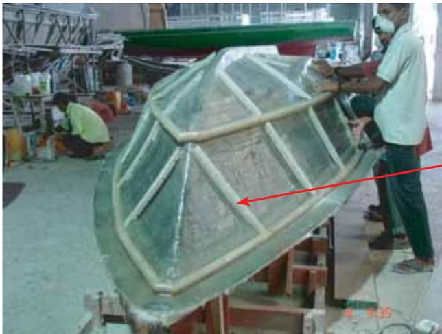
Ces deux figures montrent comment des raidisseurs fabriqués avec des tubes de stratifié de verre préformés sont mis en place et fixés avec du mastic, puis stratifiés avec au moins 5 couches de mat 450 g.
