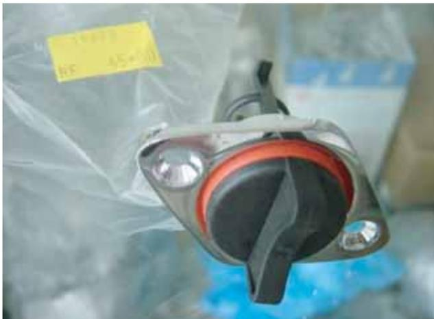
Le nable de vidange est monté dans le tableau arrière avec deux vis à têtes fraisées numéro 8 de ½ pouce.
