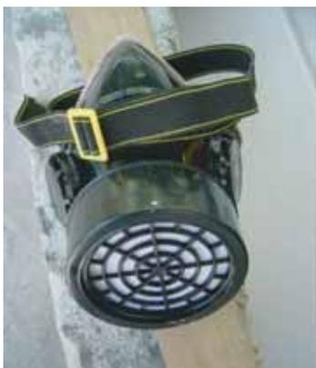
Ci-contre, l'appareil respiratoire le plus répandu pour se protéger des fumées. Le filtre sur le devant est jetable et doit être remplacé régulièrement.
