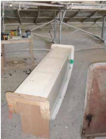
Il faut aussi construire des pièces mères séparées pour les bancs de nage avant de commencer à fabriquer le moule. Ci-contre à gauche, la pièce mère du banc de nage central.
