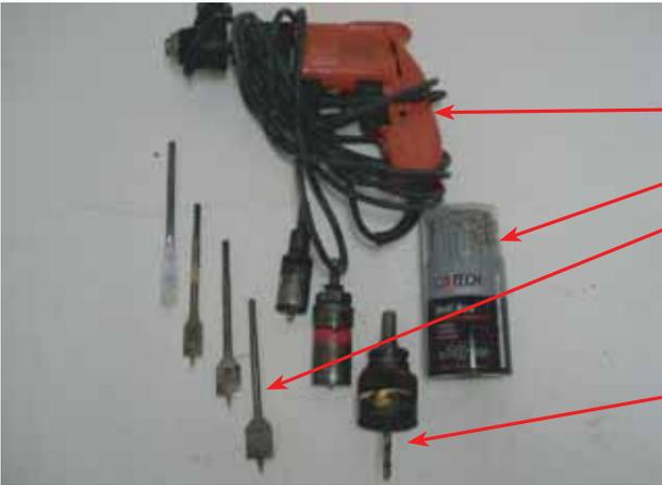
On devrait pouvoir disposer d'une perceuse électrique avec un assortiment complet de forets, de mèches plates à bois de différentes tailles pour le lamage des boulons de 6 mm des défenses en bois.
