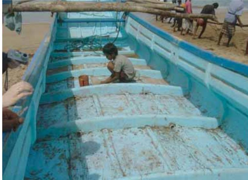
Ce bateau en stratifié de verre est une copie d'un canoë en bois. Il n'est pas vieux, mais a déjà des membrures brisées et des fissures de fatigue dans le stratifié du fond.
