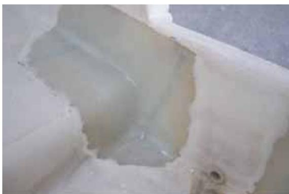
Dans cet exemple, on a opté pour la résine époxy, mais la résine vinylester aurait aussi fait l'affaire. Rappelons qu'il s'agissait d'une réparation par un seul côté et que le stratifié de polyester originel montrait déjà une moindre résistance à la fatigue.
