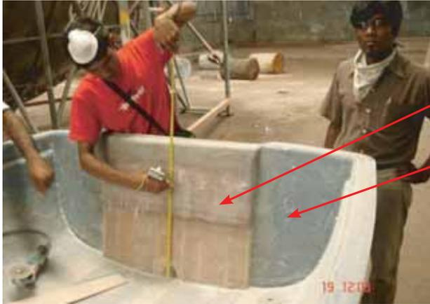
On renforce le tableau arrière en ajoutant deux couches de contreplaqué de 18 mm collées l'une sur l'autre, soit au total une épaisseur de 36 mm.
