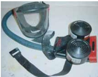
Ci-contre, un masque facial alimenté par des batteries. Le bloc-batterie se porte à la ceinture. L'air est propulsé à travers les filtres et poussé à l'intérieur du masque qui protège à la fois les yeux et les poumons.
