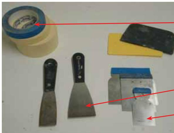
Rubans adhésifs de carrossier de deux tailles pour diverses tâches: par exemple, pour séparer deux couleurs différentes de gelcoat sur la coque pendant la construction, ou isoler une zone pour des réparations. Le ruban adhésif est aussi pratique pour fixer une bâche de plastique servant de protection contre la poussière ou la pluie.
