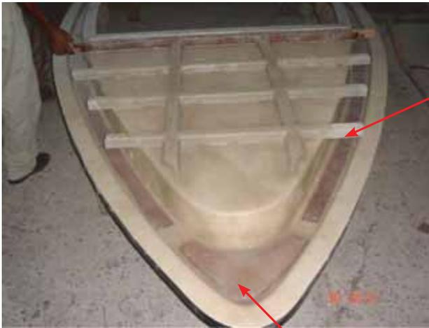
On renforce le pont en stratifiant des raidisseurs dans le pont, comme indiqué ci-contre à gauche.
