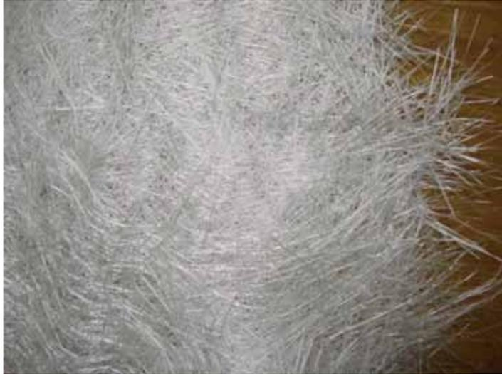
Le tissu mat est constitué de fibres de 25 à 50 mm de longueur (1 à 2 pouces) orientées de manière aléatoire et maintenues ensemble par un liant polyvinylique (PVA) soluble dans le styrène.
