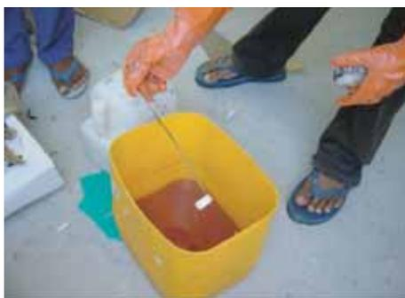
On peut fabriquer un outil pratique pour mesurer le catalyseur en attachant un fil d'acier à un bouchon de bouteille. Le contenu exact du bouchon pourra être mesuré avec une seringue.
