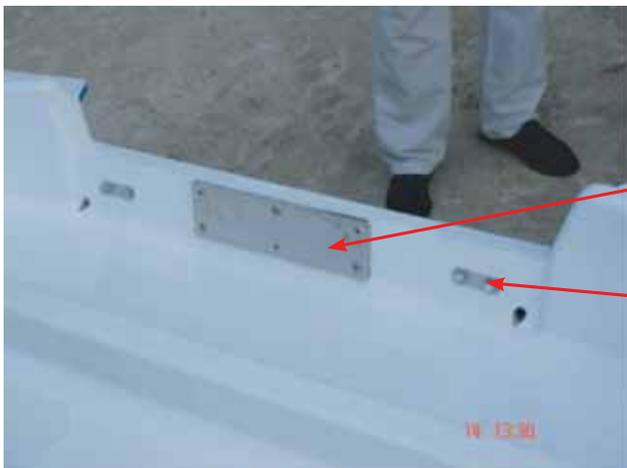
Une plaque d'acier ou d'aluminium sert de renfort supplémentaire pour le montage du moteur.
