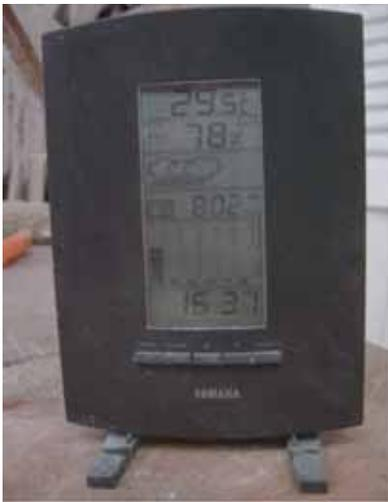
Tout atelier, même rudimentaire, utilisé pour la construction de plastiques renforcés de fibres doit avoir un appareil indiquant la température et l'humidité relative de l'air dans l'atelier.
