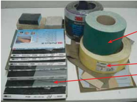
On commence par poncer le stratifié avec du papier de verre de grain 60 (ou plus gros). Les papiers abrasifs de grains 80 et 120 sont utilisés pour les travaux de finition intermédiaires.
