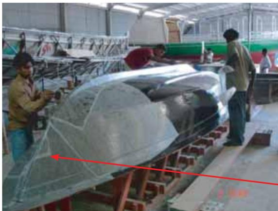
La fine première couche de tissu mat/voile de surface doit être posée avec soin. Il faut éliminer toutes les bulles d'air et la laisser polymériser séparément. À défaut d'un voile, on peut employer un mat 300 g.
