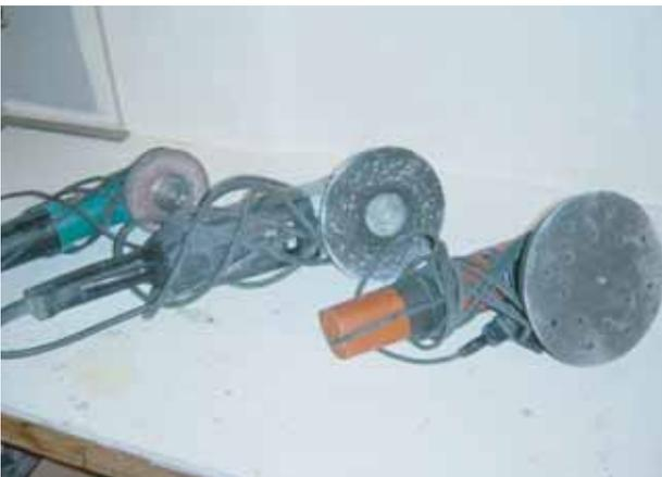
Surtout utilisées pour éliminer par ponçage le stratifié endommagé, les ponceuses/meuleuse à disques électriques servent aussi à poncer le stratifié avant l'assemblage et à améliorer les liaisons secondaires. Elles peuvent être munies de disque papier de grain 40 à utiliser avec un disque support en caoutchouc.
