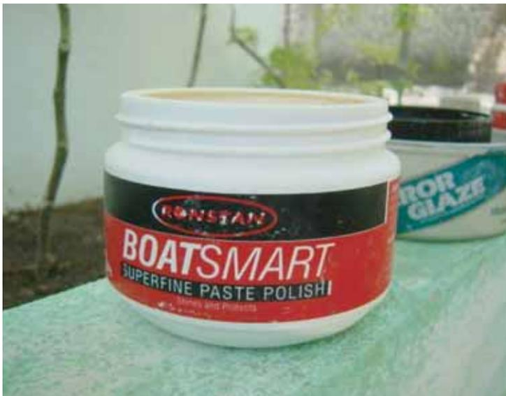
Un agent de polissage (ou pâte à polir) se présente en différentes qualités (brut, fin ou superfin). Ce produit sert à obtenir un nouveau fini de haute brillance dans un moule ou lorsqu'on répare une coque en stratifié. On commence par poncer la surface avec du papier abrasif à l'eau, de grains 240 à 1200 (voir la Figure 14). Ensuite on polit la surface avec une pâte brute. Enfin, après un nettoyage complet, on polit la surface avec une pâte fine puis avec de la cire.
