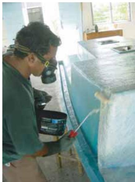
Ce constructeur naval est en train de saturer les fibres du tissu mat avec de la résine de polyester, au moyen d'un rouleau à résine.
