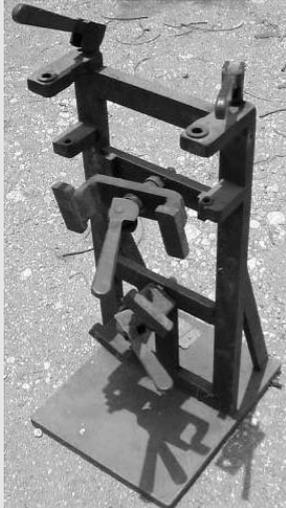
Figure 34 : Gabarit avec serrage à excentrique
