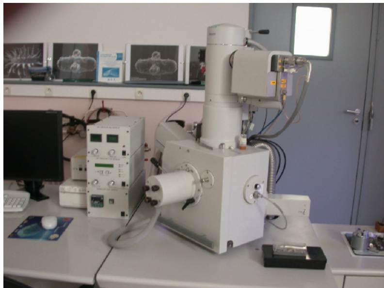
Fig. 18. Microscope électronique à balayage (M.E.B.) FEI XL30 ESEM (U.S.A.) utilisé pour les différentes observations phytoderologiques des feuilles des plantules du pistachier de l'Atlas.
