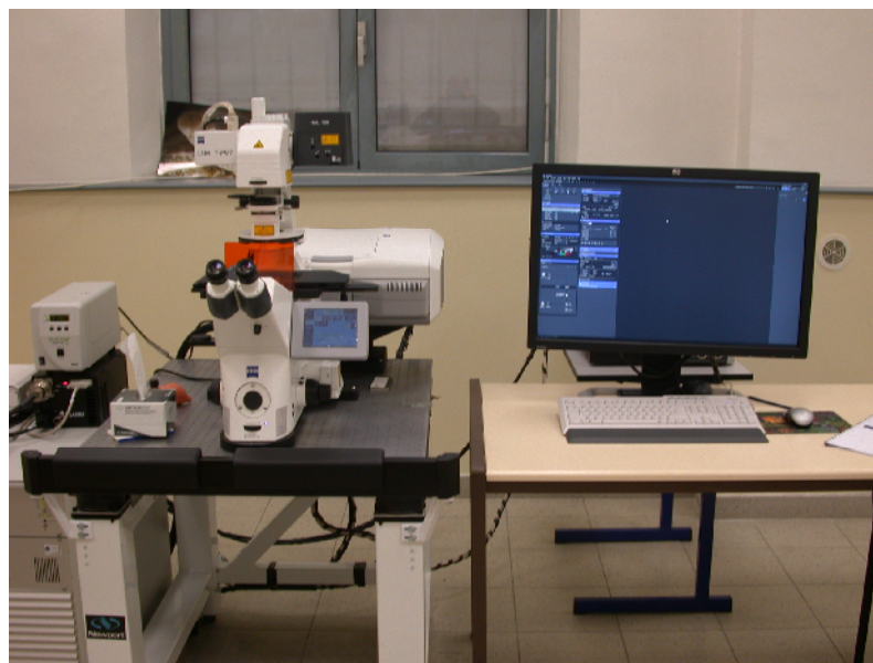
Fig. 27. Microscope Confocal de l'université de Provence (LSM 710, ZEISS) utilisé pour l'imagerie fonctionnelle.
