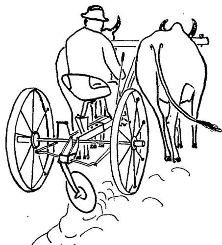
Fig. 35. — Charrue à disque (Ø 45 cm) sur polyculteur (Inde)
