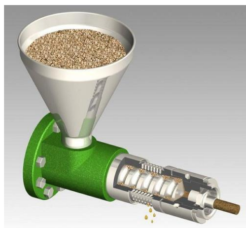
Figure 25 : Vue détaillée des composants d'une presse à vis
