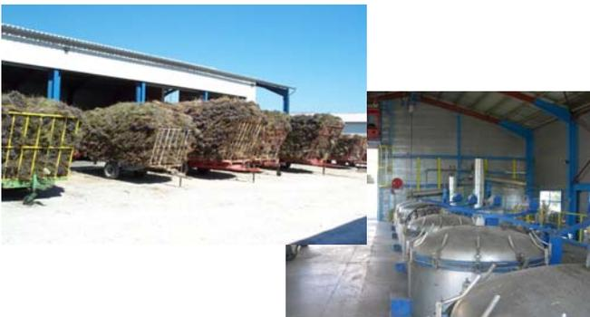
L'hydrodistillation est réalisée sur du végétal préfané, dans des alambics statiques traditionnels.
