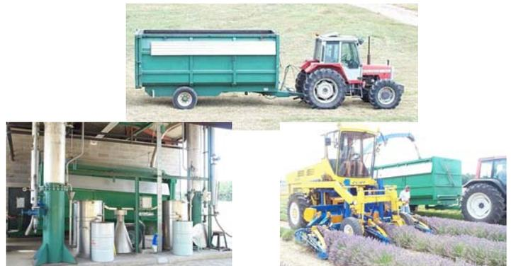
La distillation est réalisée sur du végétal soit frais soit préfané, qui est broyé et chargé dans des caissons mobiles. Elle a lieu directement dans le caisson qui remplace l'alambic.
