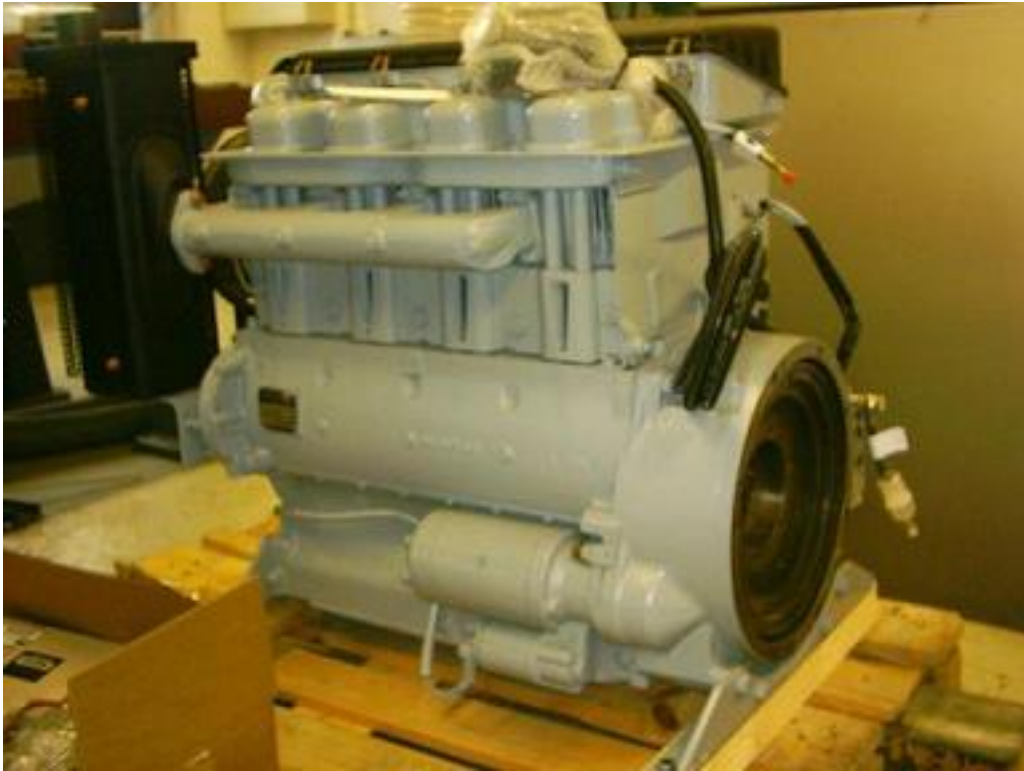
(Figure : (A.13), laboratoire AAN ; Moteur Hatz, 4 cylindres, refroidi par air, 30 à 50 kW)
