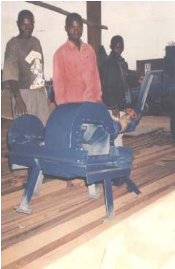
Photo de la turbine de Butembo, dans laquelle sera montée la roue
