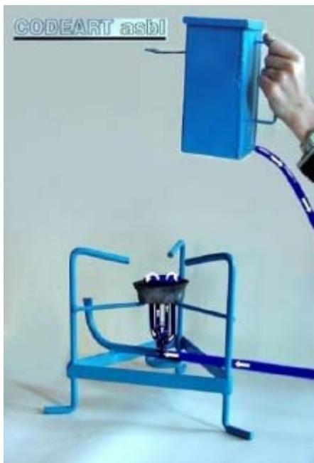
Les flèches montrent le chemin d'écoulement du pétrole lors de l'allumage. A ce moment le réchaud est encore froid, on fera s'écouler un peu de pétrole dans l'assiette en élevant de réservoir. Le pétrole sera allumé au moyen d'une allumette et d'un morceau de tissus qui fera office de mèche.
