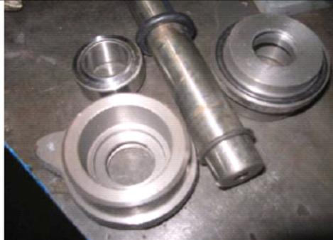
Paliers de rotor en fonte, roulements
