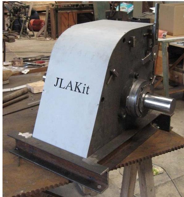
La JLAKit est l'aboutissement d'une collaboration entre le fabricant d'équipements hydroélectriques JLA&Co sprl ([www.jlahydro.be](http://www.jlahydro.be)) et l'asbl CODÉART ([www.codeart.org](http://www.codeart.org)), ONG de droit belge. Le développement de cette turbine découle de la longue expérience des ateliers Willot JLA dans la construction de turbines Banki (depuis 1988) et de l'expérience de CODÉART dans le transfert de technologie vers les pays du SUD (depuis 1988 également).
