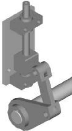
Le premier système dessiné est constitué d'une vis permettant la translation d'un écrou entre deux coussinets. A l'aide de deux leviers, le déplacement linéaire de l'écrou est transformé en mouvement de rotation. Ce système permet une grande démultiplication du mouvement de la vanne et est irréversible. Il est malheureusement compliqué à réaliser et coûteux par rapport à d'autre solution.
