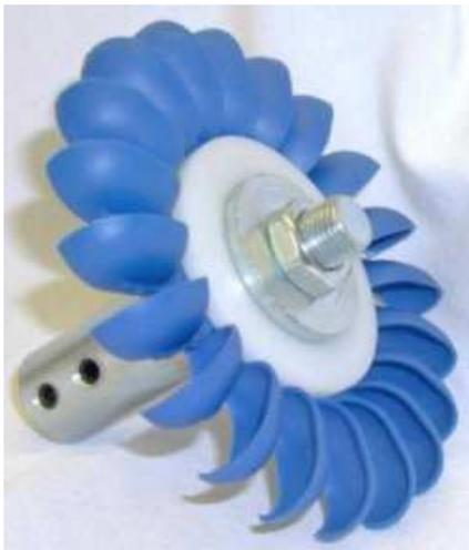
La turbine TURGO est une turbine hydraulique à action conçue pour des hauteurs de chute moyenne (200 pieds max = 60 m). Les turbines Turgo atteignent 87% d'efficacité.
