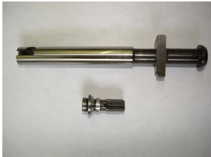
Élément de pompage et clapet de refoulement
