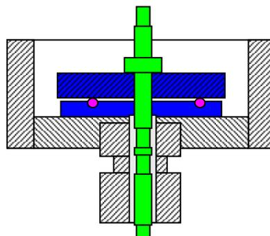
Pour fixer le tuyau  $\varnothing 40$  sur l'axe il faut utiliser la fenêtre faites sur le tuyau  $\varnothing 100$ .
