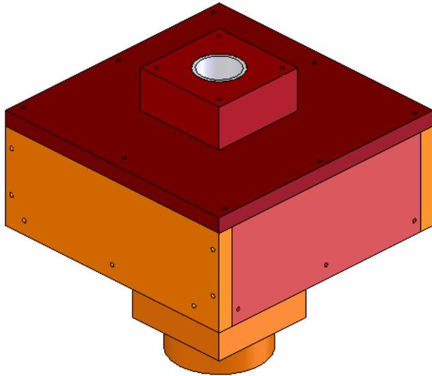
L'ensemble joue le rôle de cage à la roue pour la maintenir, ce qui la bloque horizontalement. Les billes servent à réduire les frottements.
