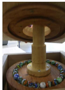
Et voilà le guide d'axe terrestre est monté ensuite vous pouvez fixer dessus l'éolienne ou la manivelle (ou autres systèmes moteur).
