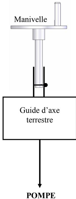
La manivelle est un système manuel qui permet en cas de problème (pas de vent, ou casse de l'éolienne) de remplacer l'éolienne.
