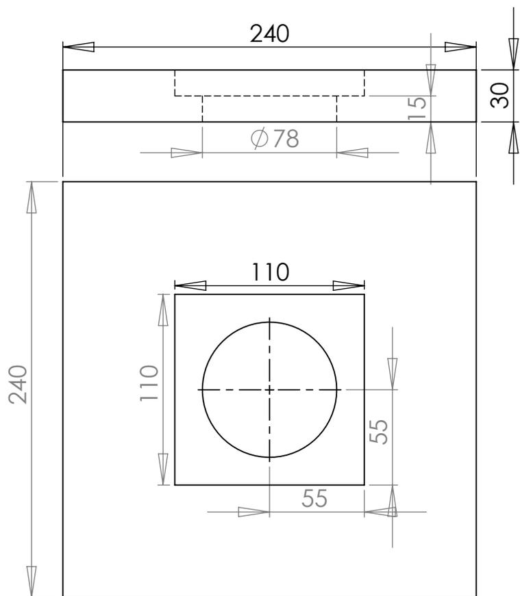
Cette extrusion permet d'encaster le palier carré de maintien fixe.
