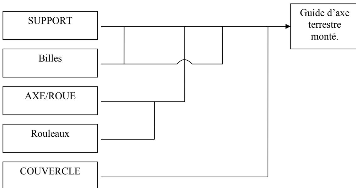
Tout d'abord il faut fixer le support sur la planche du puits (ou objet fixe par rapport au sol) mais aussi à l'axe de transmission (au tuyau  $\varnothing 100$ ).
