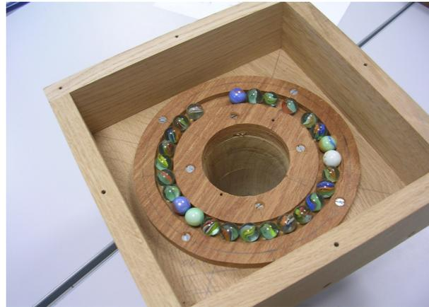
Ensuite avant de mettre l'axe il faut préparer les rouleaux comme sur la pompe. Il faut les mettre autour de la collerette en PVC, les maintenir et mettre l'axe dans le support et enfin le fixer à travers la fenêtre de l'axe de transmission au tuyau  $\varnothing 40$ .
