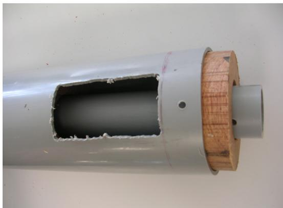
Cette fenêtre est faite au niveau des deux fixations, c'est-à-dire au niveau de la pompe et au niveau du puits pour la fixation du guide (très important de faire une fenêtre à cet endroit sinon le montage du guide est impossible)
