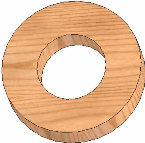
Les camemberts sont des pièces en bois rentrés de force dans le tuyau de diamètre 100. Il y a un espace faible entre les camemberts et l'axe de diamètre 40 qui le traverse pour éviter les frottements et aussi le guider.
