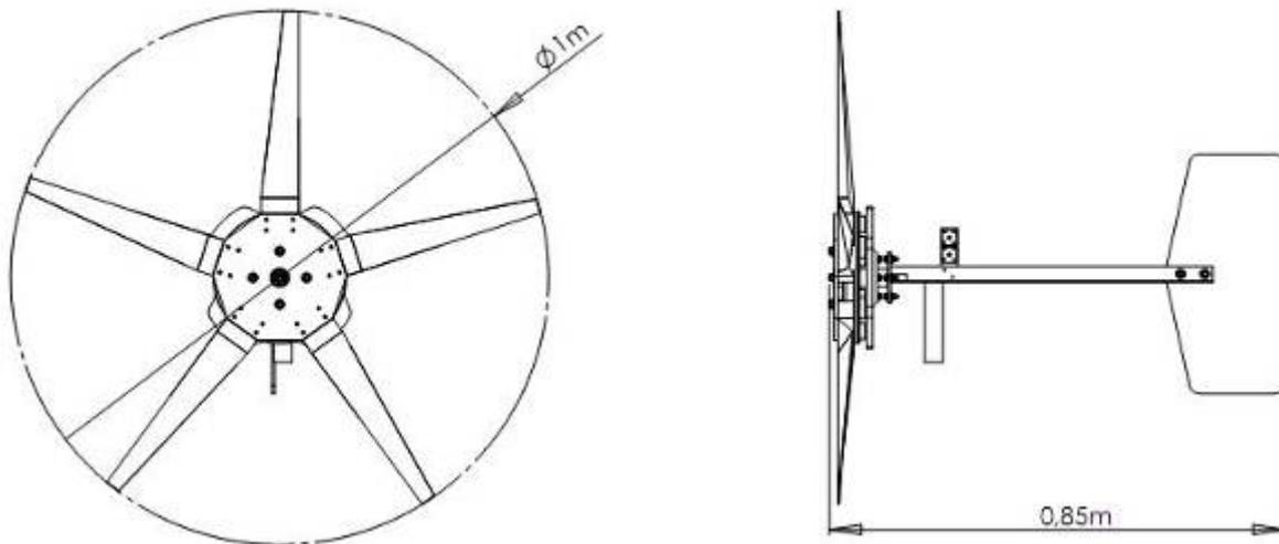
Cette puissance est atteinte pour une vitesse de vent proche de 12 m/s. De telles vitesses sont trop rares, c'est pourquoi l'éolienne est optimisée pour exploiter les vents faibles. Vous trouverez plus de détails sur les performances de la 1 à la fin de ce manuel.
