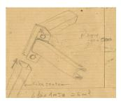
deux plateaux montés à l'aide de vis M 10 et d'écrous. Les plateaux sont réalisés entièrement en soudure à laide d'UPNs et de plaques sur lesquelles sont soudés des renforts en T.
