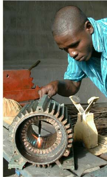
brûlage de l'imprégnation
