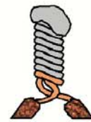
étamage de la brasure
