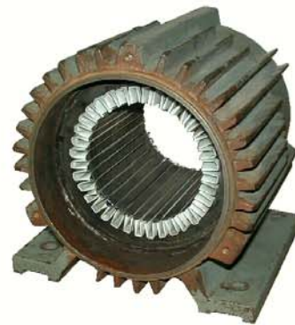
moteur équipé de ses isolations d'encoche
