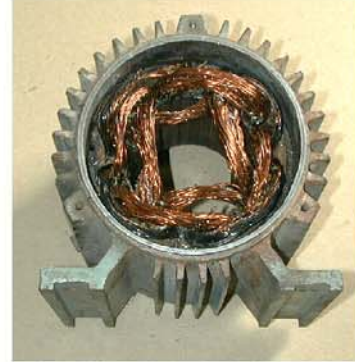
photo d'une tête de bobines (différente de celle dessinée)
