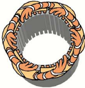
exemple d'une tête de bobines dans un moteur 36 encoches
