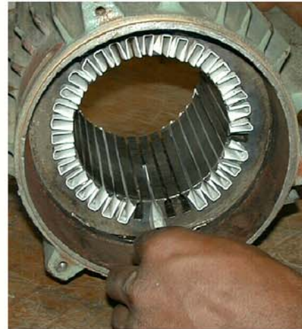
montage d'une isolation d'encoche
