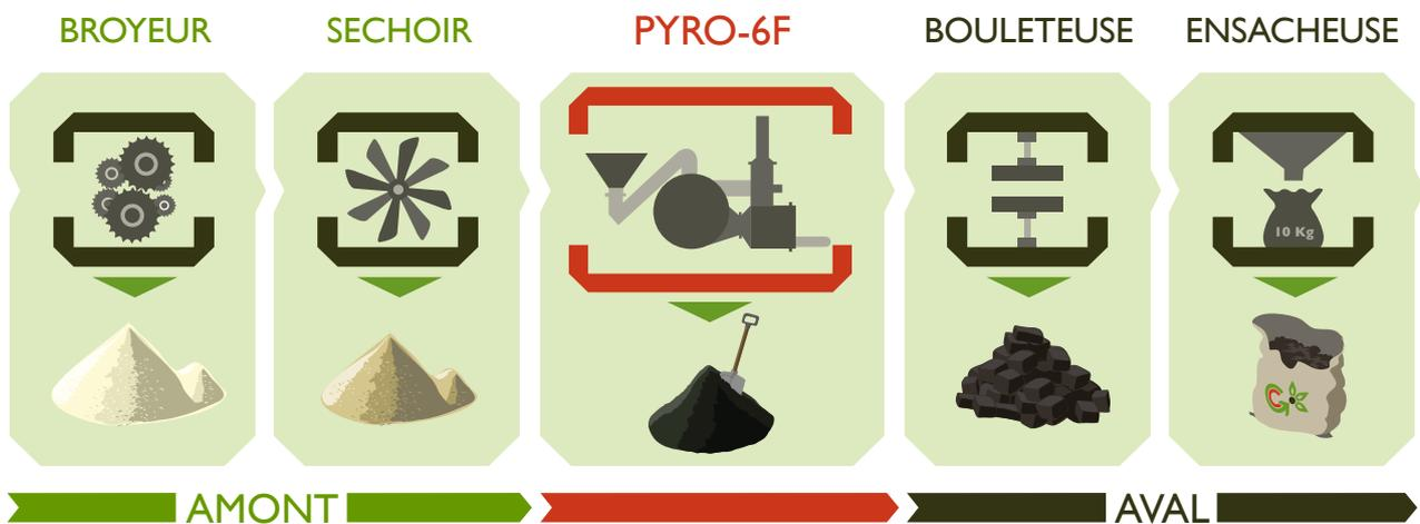
La biomasse à l'entrée du PYRO-6F doit avoir une humidité inférieure à 15% et une granulométrie maximale de 10mm.
