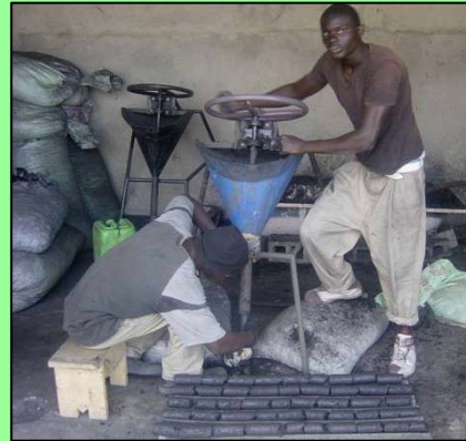
Production du biocharbon avec le Rotor Press type Haïti
