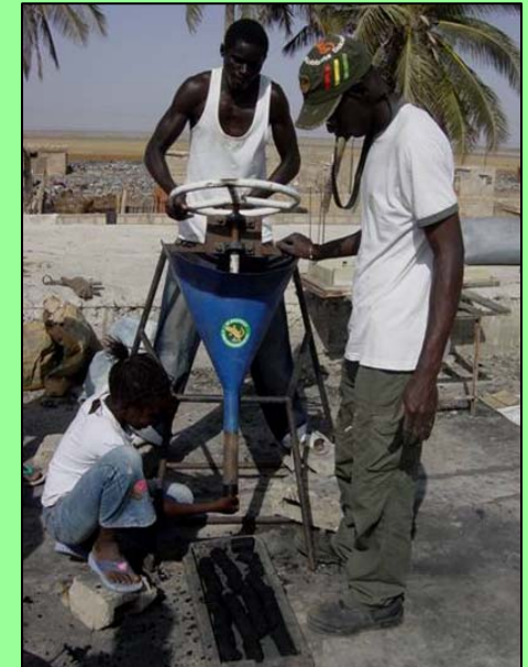
Rotor Press type Haïti (confectionné localement)
