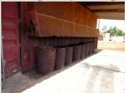
Conteneur adapté en séchoir (Bioterre - Sénégal)
