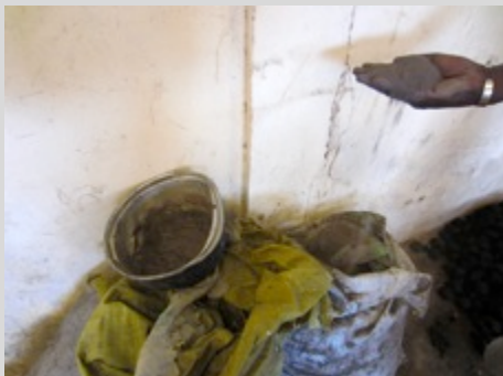
Argile utilisée comme liant (Biochar – Sénégal)
