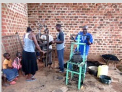
Mouleuse manuelle de type « Yeontan » (Arise - Ouganda)
