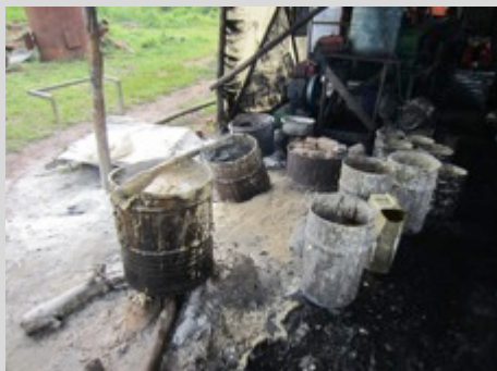
Liant fabriqué à partir de farine de manioc (Briketi – Ouganda)
