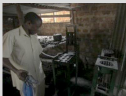
Mouleuse manuelle de type boudin à gauche et de type « Yeontan » à droite (Nicolas – Ouganda)
