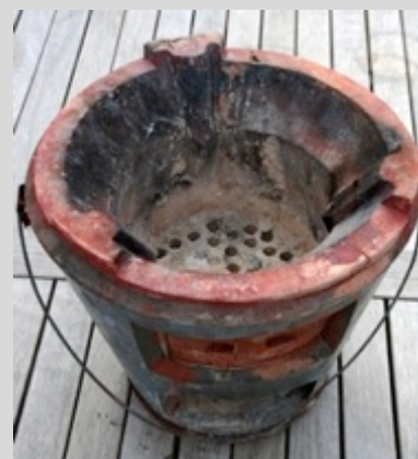
Four « bucket stove » (Source : Bisu project)
