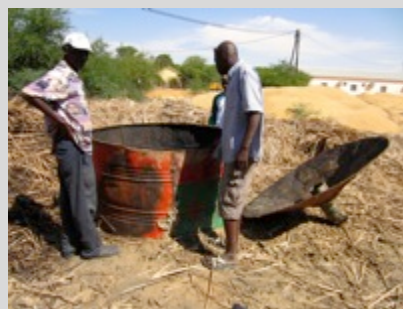
Carbonisateur de type “3 fûts” (Biochar - Sénégal)
