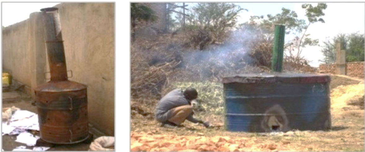
Figure 1 : Deux technologies utilisées pour la pyrolyse (Source : ARTI-TZ)
