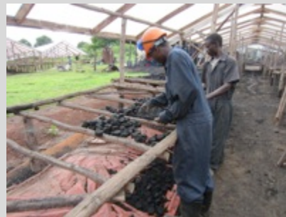
Aire de séchage bâchée (Briketi - Sénégal)
