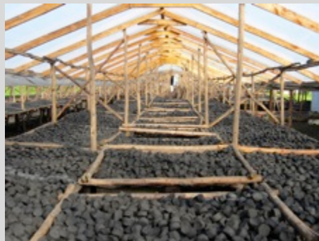
Aire de séchage d'une production de 2t/jour (Briketi – Ouganda)
