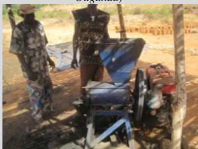
Extrudeuse motorisée (CVDB - Sénégal)
