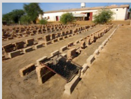
Aire de séchage d'une production potentielle de 2t/jour (Bioterre – Sénégal)
