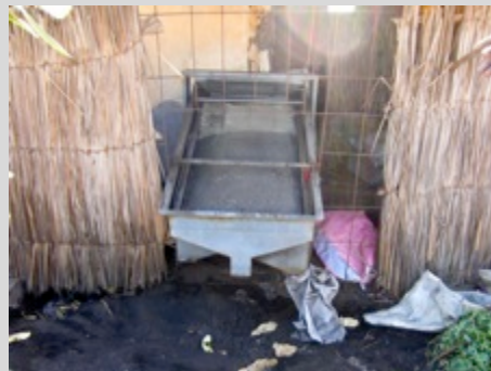
Tamiseur fixe en fer (Bioterre - Sénégal)
