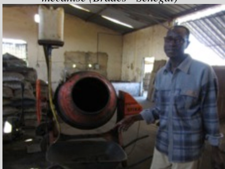
Mélangeur mécanisé, bétonnière modifiée (Bioterre - Sénégal)
