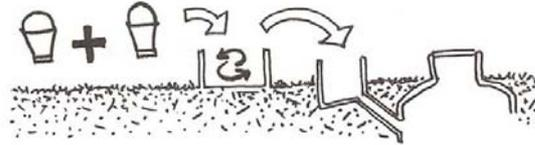
1. Les déchets des animaux et l'eau peuvent être mélangés dans une proportion de 1:1 et déposés dans le digesteur (un seau d'eau pour un seau de bouse)
