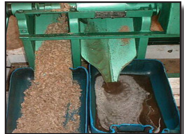
Le coco parfaitement séché peut alors être pressé. La pression mécanique, à froid se fait en trois passages. L'huile obtenue est ensuite décantée puis filtrée.
