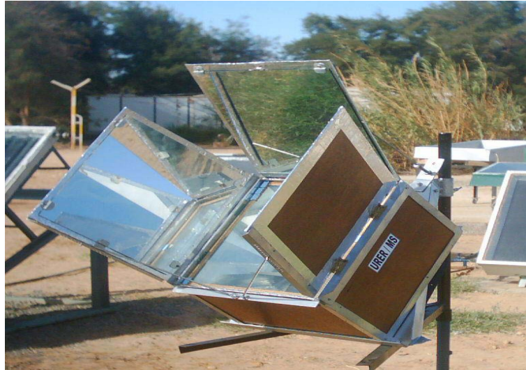
Fig. 4: Vue du cuiseur solaire boîte sur banc d'essai expérimental à l'URER/MS
