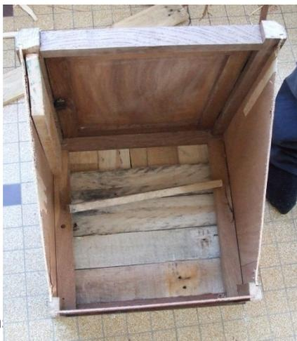
Sur la photo, le tiroir a été retiré et remplacé par 2 couches de palettes, la troisième couche sera de l'isolant, qui sera à son tour recouverte par une couche de palette et une fine lamelle de bois (récupérée sur le meuble, **rien ne se perd, tout se transforme** !).
