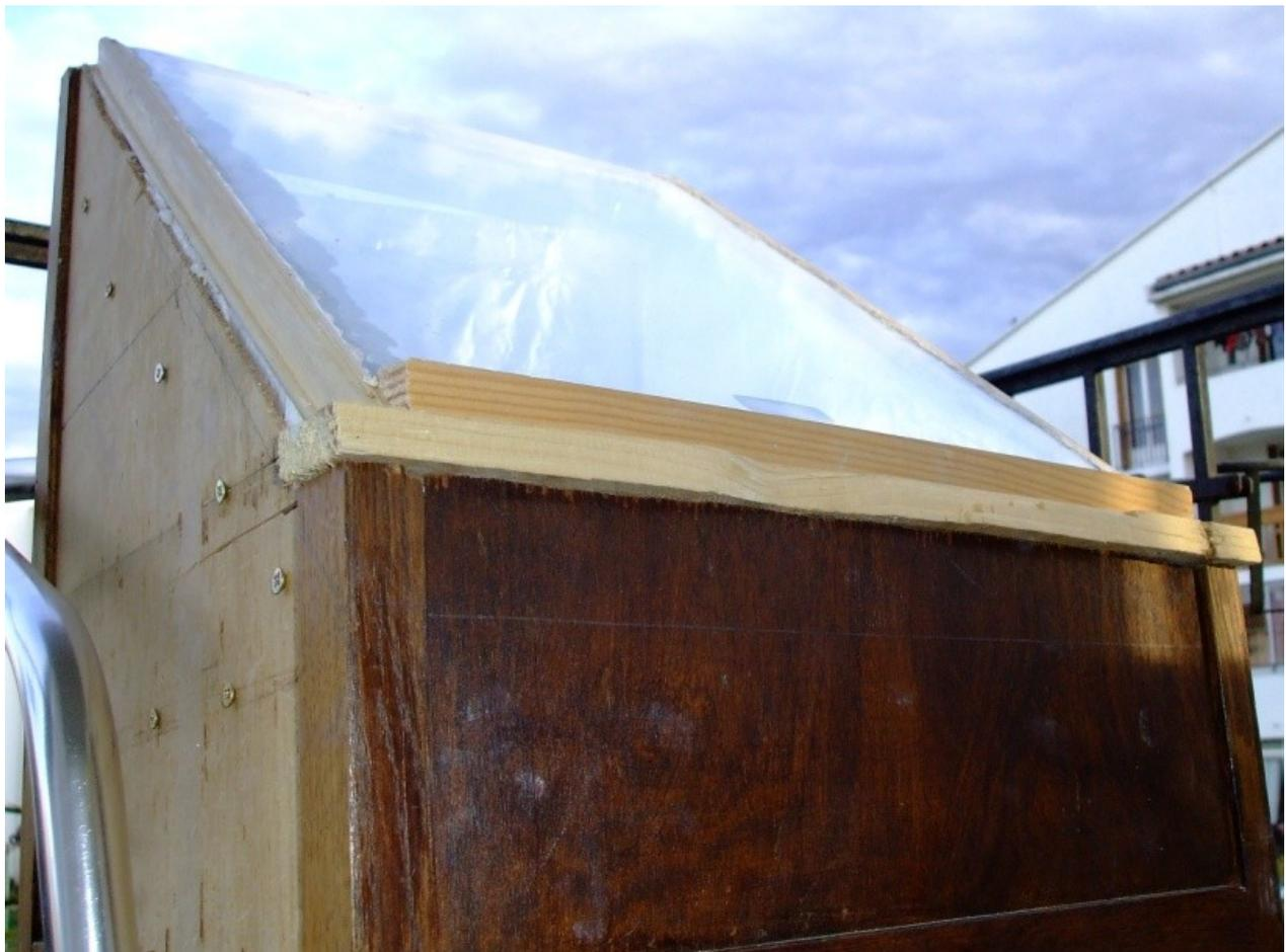
Bref, le four est terminé ! Nous avons aussi fait des panneaux réflecteurs pour le dessus, le dessous et les cotés ! Il suffit d'avoir du carton (1 m de long et la largeur du vitrage). Pour les maintenir au bon angle, nous avons seulement utilisés un système de crantage. On fixe au carton un bout de bois taillé avec plusieurs crans, sur le four on dispose la barre en bois et le tour est joué.
