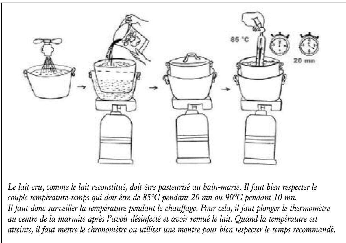
Figure 14 - Pasteurisation du lait cru et du lait reconstitué.
